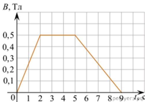
На рисунке приведён график зависимости модуля индукции  $B$  магнитного поля от времени  $t$ . В это поле перпендикулярно линиям магнитной индукции помещён проводящий прямоугольный контур сопротивлением  $R = 50$  мОм. Найдите площадь контура, если за все время в контуре выделилось 1,5 мДж теплоты.
