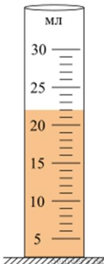
Какой объём в мензурке занимает налитая в неё вода (см. рис.), если погрешность измерения равна половине цены деления? Ответ дайте в мл. В ответе запишите значение и погрешность слитно без пробела.
