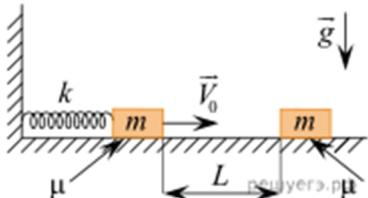
На горизонтальной шероховатой плоскости (коэффициент трения равен  $\mu$ ) покоятся два одинаковых груза массой  $m$  на расстоянии  $L$  друг от друга, один из которых соединён со стенкой лёгкой нерастянутой горизонтальной пружиной жёсткостью  $k$  (см. рис.). Левому грузу сообщили в некоторый момент начальную скорость  $V_0$  в направлении правого, после чего грузы испытали абсолютно упругое лобовое столкновение. На какое расстояние  $l$  сместится после столкновения правый груз?
