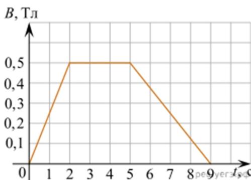
На рисунке приведён график зависимости модуля индукции  $B$  магнитного поля от времени  $t$ . В это поле перпендикулярно линиям магнитной индукции помещён проводящий прямоугольный контур сопротивлением  $R = 50 \text{ мОм}$ . Найдите площадь контура, если за все время в контуре выделилось  $1,5 \text{ мДж}$  теплоты.
