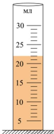
Какой объём в мензурке занимает налитая в неё вода (см. рис.), если погрешность измерения равна половине цены деления? Ответ дайте в мл. В ответе запишите значение и погрешность слитно без пробела.
