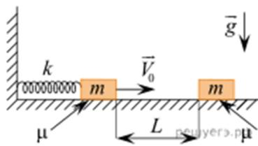
На горизонтальной шероховатой плоскости (коэффициент трения равен  $\mu$ ) покоятся два одинаковых груза массой  $m$  на расстоянии  $L$  друг от друга, один из которых соединён со стенкой лёгкой нерастянутой горизонтальной пружиной жёсткостью  $k$  (см. рис.). Левому грузу сообщили в некоторый момент начальную скорость  $V_0$  в направлении правого, после чего грузы испытали абсолютно упругое лобовое столкновение. На какое расстояние  $l$  сместится после столкновения правый груз?
