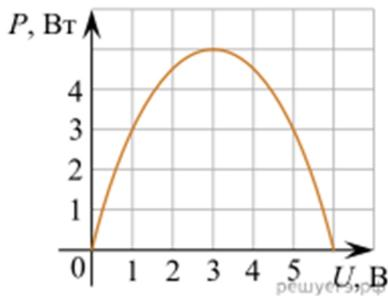
Электрическая цепь состоит из батареи с ЭДС  $\mathcal{E}$  и внутренним сопротивлением  $r$  и подключённого к ней резистора нагрузки с сопротивлением  $R$ . При изменении сопротивления нагрузки изменяется напряжение на ней и мощность в нагрузке. На рисунке представлен график зависимости мощности, выделяющейся на нагрузке, от напряжения на ней. Используя известные Вам физические законы, объясните, почему данный график зависимости мощности от напряжения представляет собой параболу.
