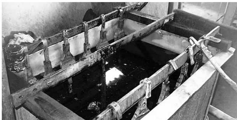
Ванна хромирования [Chromium plating bathtub]
